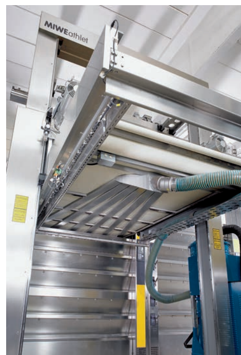
Automatyczne czyszczenie blach? To łatwe, dzięki automatycznemu odsysaniu okruszków (MIWE athlet XL i XXL).
